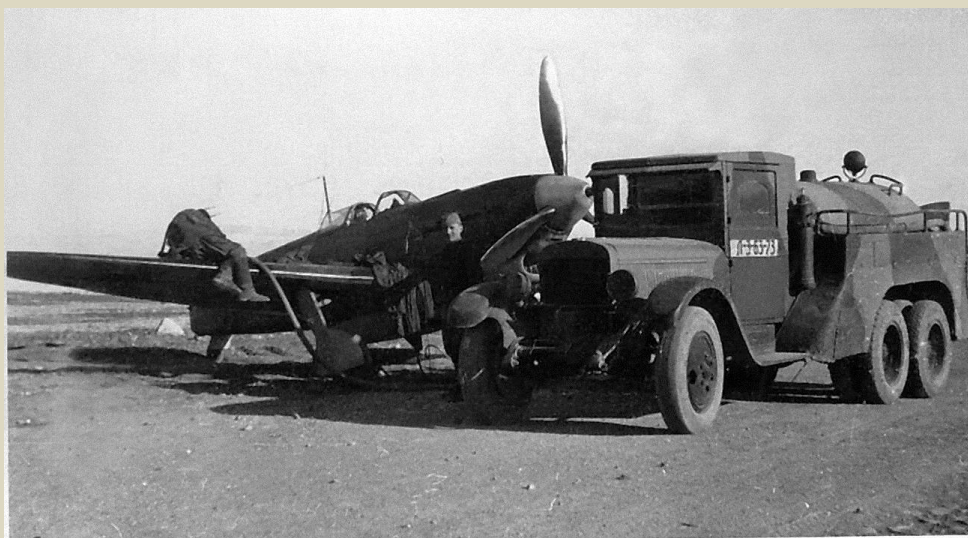
Заправка топливом истребителя Як-9 из 14-го гвардейского истребительного авиаполка. Рядом с самолетом аэродромный заправщик БЗ-335 на базе автомобиля ЗиС-6.
